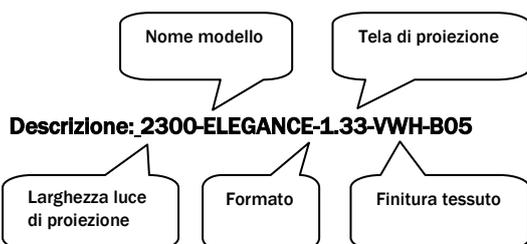
**Dimensioni della luce di proiezione:** questa parte del codice indica la larghezza della luce di proiezione in millimetri.
