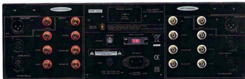
La vue du circuit et de la face arrière sont éclairants : ce préamplificateur est un véritable double mono dont les sections sont clairement séparées.
