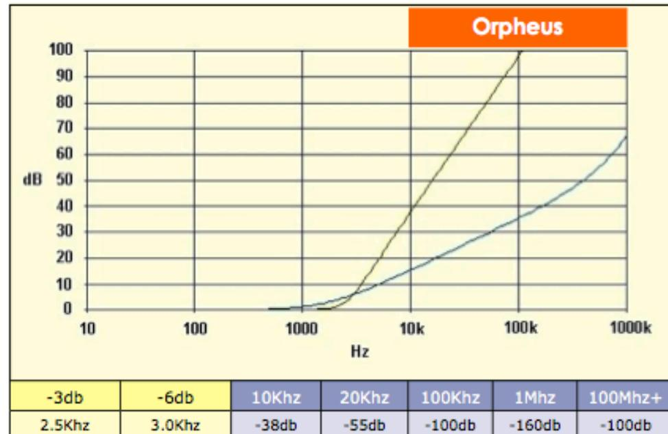
Il grafico esprime l'attenuazione in db in funzione della frequenza. La curva in giallo rappresenta l'attenuazione dei disturbi di modo differenziale, mentre la curva in blu si riferisce a quelli di modo comune.
