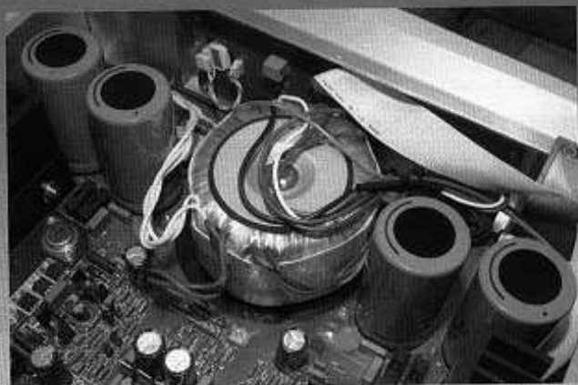
△ Maestro Settantia 動用四支體積仿如 250 毫升罐裝飲品相若 Nippon-Chemicon 15,000 微法拉電解大水塘作能量儲備，夾在中間者則為 400VA 高流量環型變壓器。
