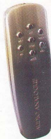
La télécommande semble taillée dans un bloc de métal massif. Elle permet de sélectionner directement la sensibilité, MM ou MC, du préamplificateur phono.
