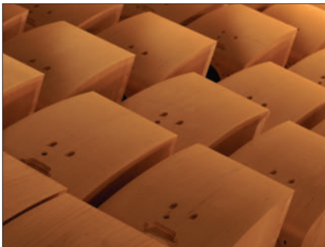
Alcuni mobili della 704 pronti per la lucidatura. Vengono effettuati molti controlli di qualità all'interno della catena produttiva. Tali controlli partono dal legno, appena arriva in fabbrica, per concludersi con l'assemblaggio degli altoparlanti.
