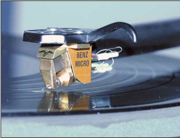
L'immagine mostra il magnifico corpo nudo della Glider montato su un braccio Rega RB-300. L'assenza totale di protezione impone il massimo della cautela nella fase di montaggio del fonorielatore.
