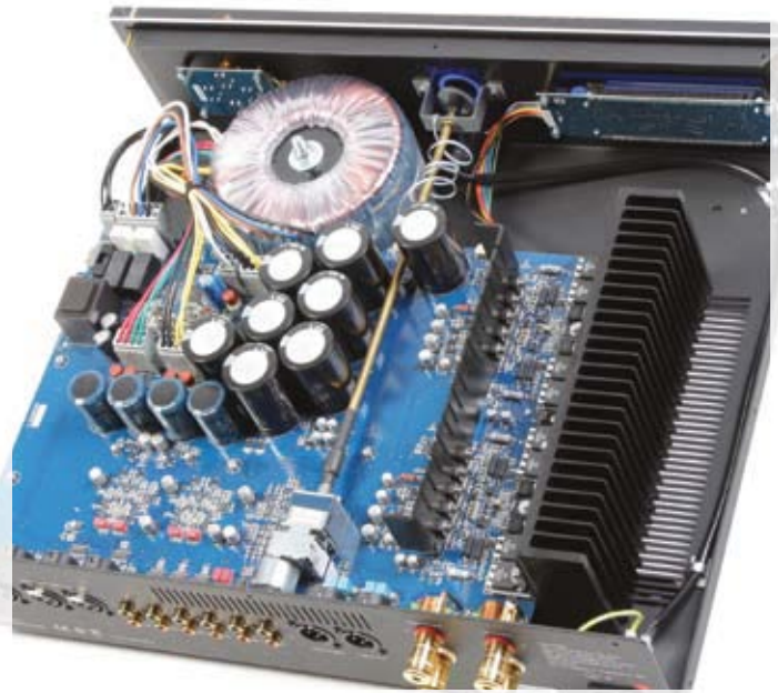
EC-Kraftformel: 500-Watt-Haupttrafo, acht 10000-Mikofarad-Speicherelkos für die Endstufe und stattliche Extra-Elkos für die Vorstufe.
