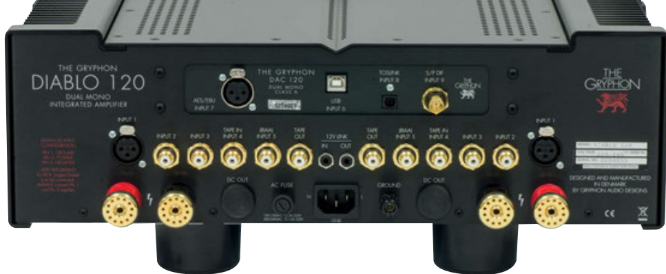
Il pannello posteriore appare perfettamente simmetrico. Gli ingressi analogici sono 5, uno dei quali bilanciato. Dal riquadro superiore sporgono le prese del modulo opzionale (fono o DAC), in questo caso l'unità DAC 120 che rende disponibili un AES-EBU bilanciato e due S/PDIF, elettrico ed ottico.
