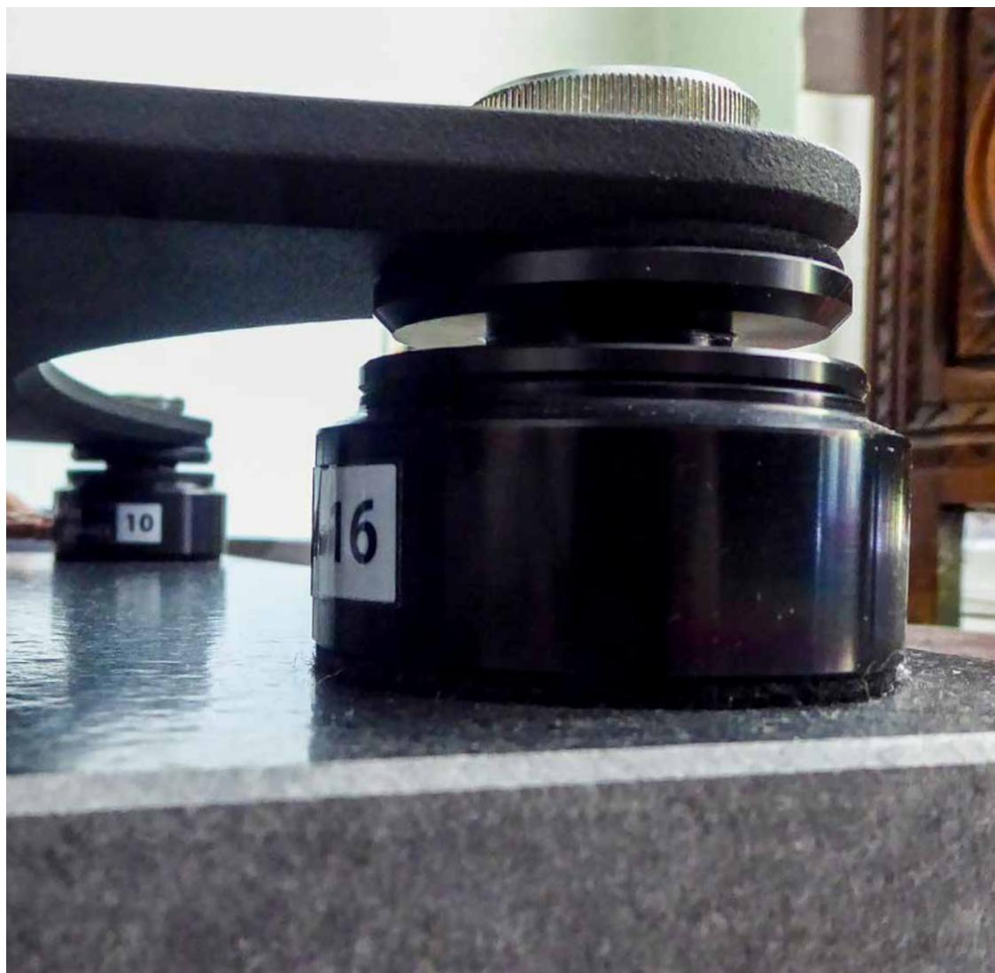
ein präzise laufendes Feingewinde erfolgt die Höhenjustage. Ein ringförmiger Neodym-Magnet umfasst den mit dem oberen Teil verbundenen zylinderförmigen Magnet. Auf diese Weise wird er frei schwebend in Position gehalten, sodass in der Vertikalen sowohl Druck- als auch Zugkräfte aufgenommen werden können.
