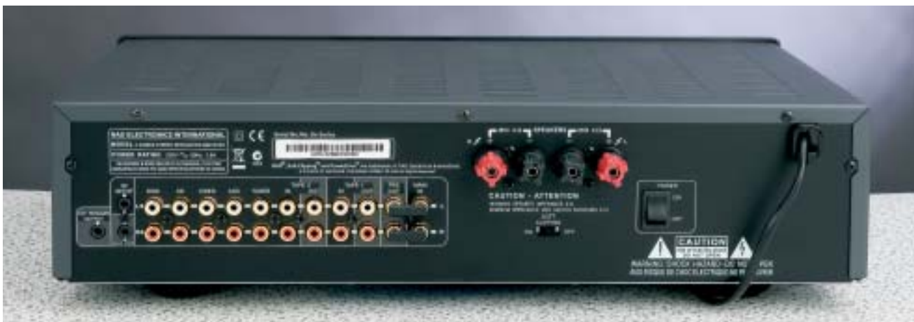
Ben 7 ingressi linea più l'ingresso MP (Media Player) posto sul pannello frontale rappresentano un'ottima dotazione. L'interruttore per l'attivazione del circuito Soft Clipping è posizionato al di sotto della morsetteria degli altoparlanti.
