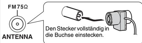
Wenn der DVD-Receiver soweit betriebsfertig ist, müssen Sie einen UKW-Sender suchen und anhand seiner Feldstärke die optimale Position für die UKW-Zimmerantenne ermitteln.
