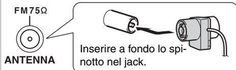
Quando il ricevitore DVD è pronto per l'uso occorre sintonizzarsi su una stazione radio FM e regolare la posizione dell'antenna FM in modo da ottenere la migliore ricezione possibile.
