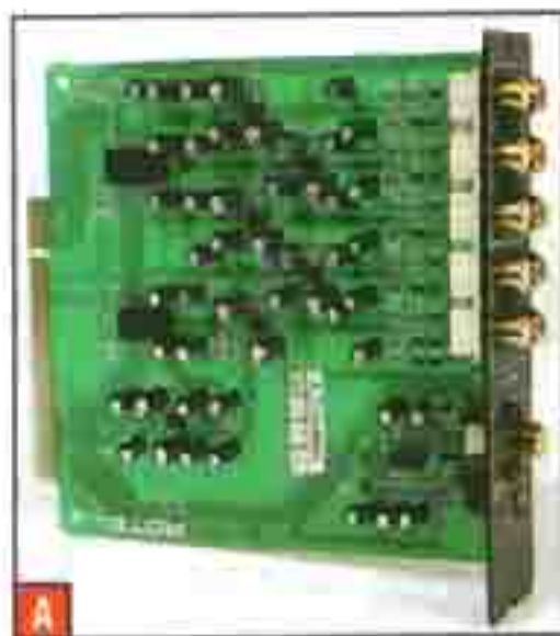
A • Le uscite audio (solo stereo) e video accessorie duplicate anche per la zona due trovano posto su una scheda separata che ospita anche la connessione d'uscita al tape.
