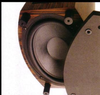
Der ovale Basstreiber belegt nahezu die gesamte Sockelfläche. Die betont bodennahe Anordnung bewirkt eine sehr intensive Raumanregung und spart einiges an Hub und Verstärkerleistung.
