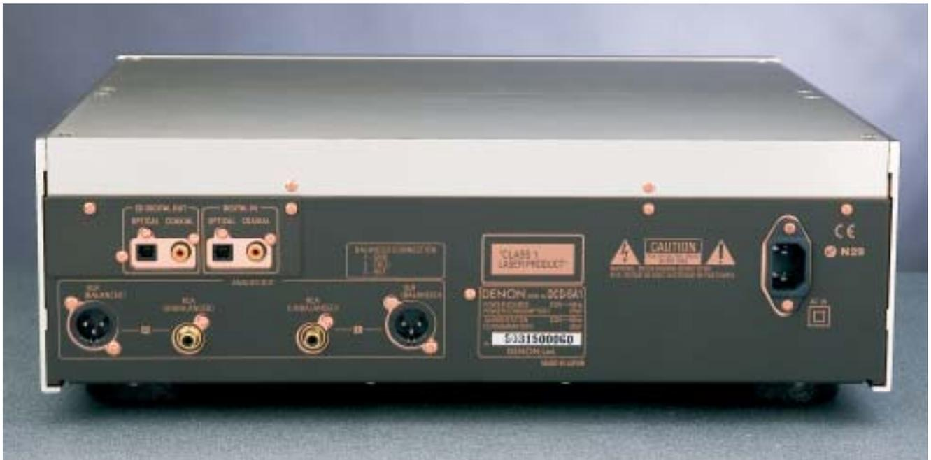
*Il pannello posteriore offre varie possibilità di collegamento: si va dalle uscite terminate su pin-jack a quelle bilanciate, per finire con una coppia di uscite digitali. Data la qualità degli stadi di conversione ed analogici è possibile utilizzare il DCD-SA1 come convertitore D/A per sorgenti esterne; allo scopo si utilizzano le due prese marcate DIGITAL IN.*
