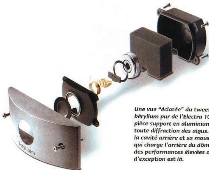
Une vue "éclatée" du tweeter IAL en béryllium pur de l'Electra 1007 Be avec sa pièce support en aluminium massif évitant toute diffraction des aigus. Remarquez aussi la cavité arrière et sa mousse amortissante qui charge l'arrière du dôme. Tout le secret des performances élevées de ce tweeter d'exception est là.
