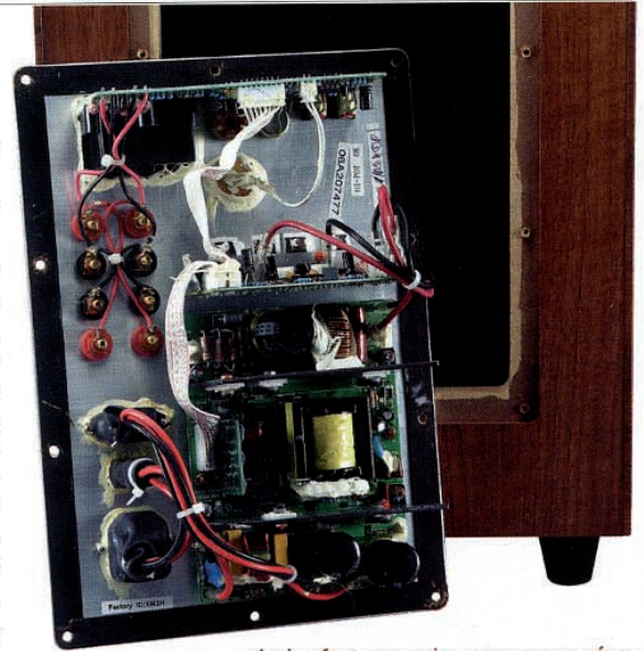
L'amplificateur numérique de 300 W, à technologie BASH, est solidaire du panneau arrière. Un circuit auxiliaire gère le filtrage.
