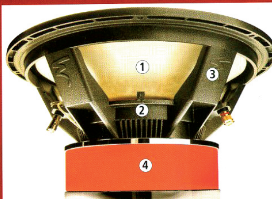
Woofer de 40 cm ElectroMagnetic EM. 1 - Nouvelle membrane W. 2 - Support spider décalé. 3 - Saladier ultra rigide. 4 - Pot enfermant l'électro-aimant remplaçant l'aimant permanent. Poids total 24 kg !
