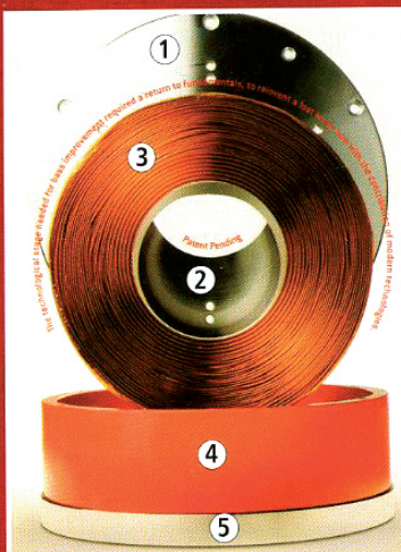
Woofer de 40 cm ElectroMagnetic EM. 1 - Nouvelle membrane W. 2 - Support spider décalé. 3 - Saladier ultra rigide. 4 - Pot enfermant l'électro-aimant remplaçant l'aimant permanent. Poids total 24 kg !
