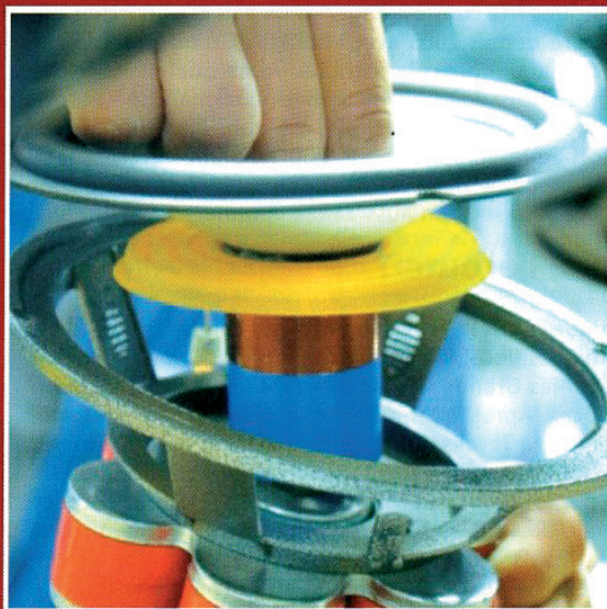
Nouveau médium Power Flower W en cours de montage de l'équipage mobile. On remarquera le circuit magnétique multi-aimant organisé à la manière des pétales d'une fleur, d'où son nom, la bague de centrage bleue de la bobine mobile et du spider, le cône W avec sa suspension périphérique.
