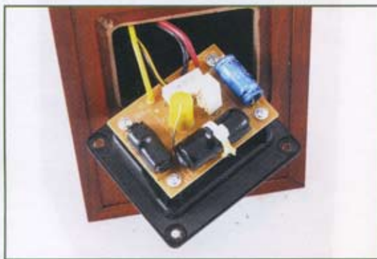
Crossover semplice ma ben realizzato. Direste trattarsi del filtro di una coppia di diffusori da 200 euro?
