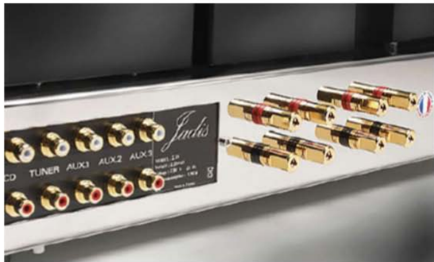
Lo spettacolare retro dell'ampli francese offre 5 ingressi ad alto livello e 2 coppie di morsetti d'uscita per ciascun canale.
