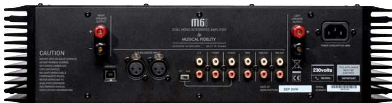
L'implantation des prises semble suggérer que la partie préampli est située à l'arrière du circuit interne et que l'étage d'amplification est double mono.
