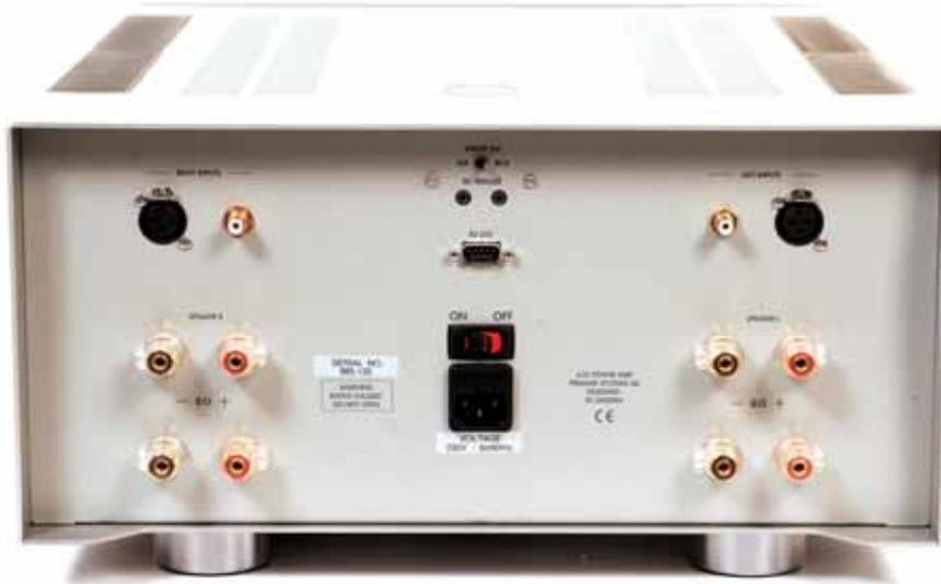
Connessioni disposte come da manuale, molto comode e ben serrabili le uscite sdoppiate, per consentire il bi-wiring, dei cavi di potenza. Ingressi anche bilanciati. Al centro, dall'alto in basso, l'ingresso del contatto che consente l'accensione simultanea del finale dal suo pre, l'interruttore di accensione, la vaschetta per il cavo di alimentazione.
