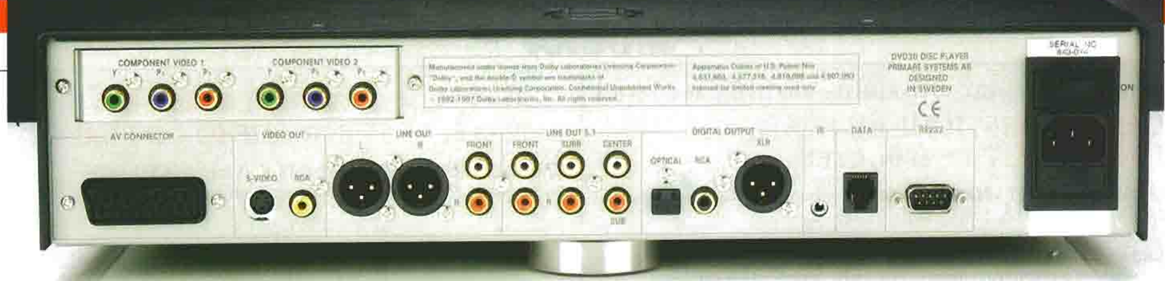
Sul pannello posteriore si possono notare i connettori XLR bilanciati utilizzati per l'uscita analogica stereofonica e per l'uscita audio digitale. Per il resto la dotazione di connettori si può considerare piuttosto ordinaria, se si eccettua la disponibilità di una seconda uscita component.
