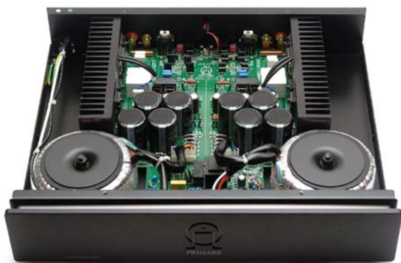
Il finale A-30.2 è veramente "dual-mono": due i trasformatori di alimentazione; nel particolare i 4 dispositivi d'uscita per ciascun canale.
