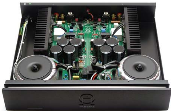
Il finale A-30.2 è veramente "dual-mono": due i trasformatori di alimentazione; nel particolare i 4 dispositivi d'uscita per ciascun canale.
