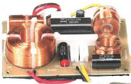
Il crossover è sviluppato su un ampio PCB fissato alla parete laterale e isolato con uno strato di neoprene. Eccellente la componentistica con induttori avvolti in aria e condensatori a film in polipropilene metallizzato. Viene utilizzata una linea ad alta pendenza progressiva sul tweeter e una invece abbastanza blanda sul woofer con una RLC di equalizzazione poco dopo la frequenza di incrocio.
