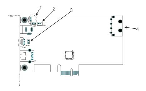
JP401, JP402 : External power input jack enable jumper 외부 전원 사용여부를 설정 합니다.
