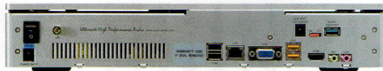
sMS-1000SQ Windows Editionの背面。こちらはUSB出力を搭載したモデル。設定時にはディスプレイをつないでパソコンとして使用することもできる
