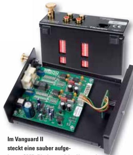
Im Vanguard II steckt eine sauber aufgebaute SMD-Platine, auf der Unterseite sorgen „Mäuseklaviere“ für hohe Flexibilität
