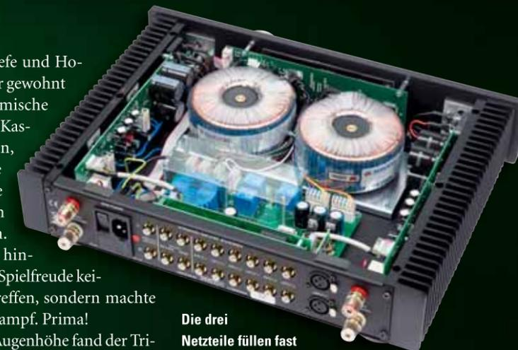
Die drei Netzteile füllen fast den gesamten Energy. Die Endstufen sitzen seitlich, innen an den Kühlkörpern
