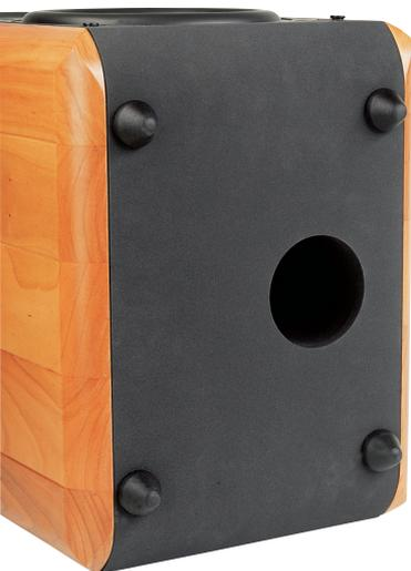
Dadurch, dass die Bassreflex-öffnung nach unten mündet, muss die Box einige Zentimeter „Luft“ nach unten haben. Dafür sorgen die passend gestalteten Füße aus weichem Gummi, die gleichzeitig vom Untergrund entkoppeln
