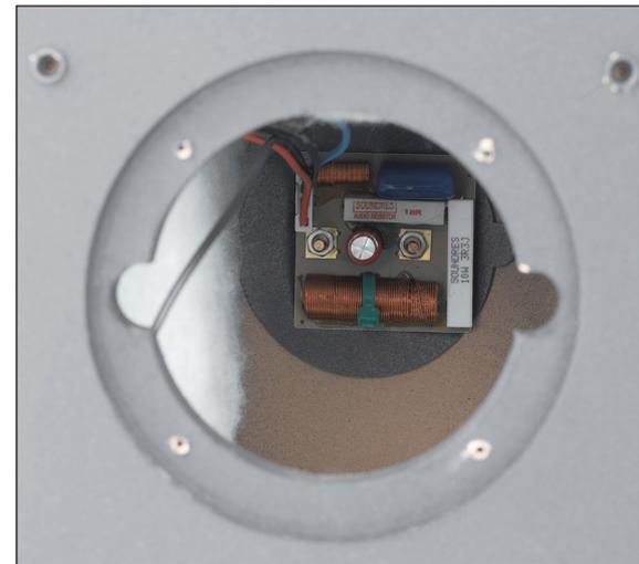
Die Frequenzweiche der Box sitzt auf der Rückwand hinter dem Hochtöner, direkt gegenüber dem Anschlussterminal
