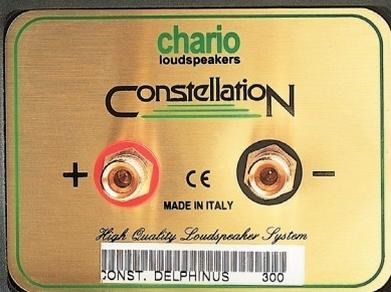
Auf Bi-Wiring hat Chario bewusst verzichtet, die Box trägt lediglich ein paar solider, vergoldeter Anschlussklemmen auf einer in die Rückseite der Box eingelassenen Metallplatte
