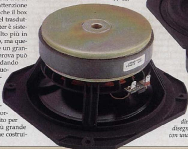
Uno dei due trasduttori per le note basse. Notare il complesso magnetico ben dimensionato. Il trasduttore, appositamente disegnato, si distingue per escursioni notevoli con una linearità veramente degna di nota.
