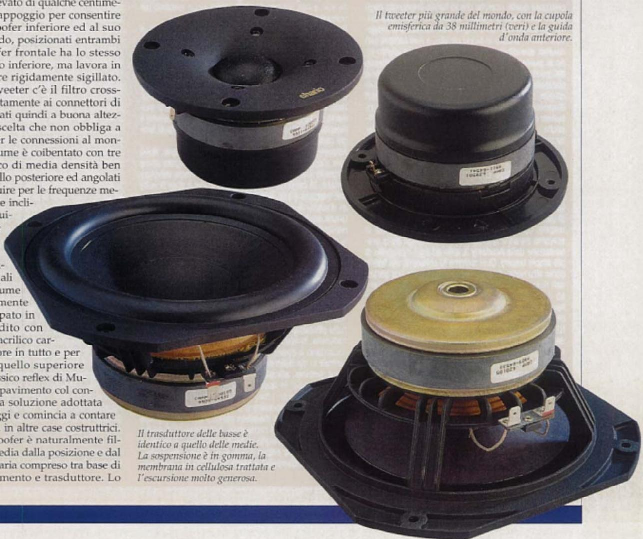
*Il trasduttore delle basse è identico a quello delle medie. La sospensione è in gomma, la membrana in cellulosa trattata e l'escursione molto generosa.*
