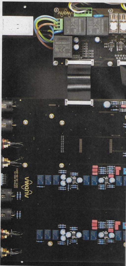
L'elettronica è basata su componenti dalle ottime caratteristiche e applicazioni schiettamente audiofile: condensatori elettrolitici Nichicon, condensatori audio Wima serie Red, commutatori Alpha, potenziometri motorizzati Alps Alpine. A bordo troviamo una circuitazione DAC basata sul chip Asahi Kasei AKM AK4490REQ, l'alimentazione è dual mono e i trasformatori sono realizzati appositamente per questo amplificatore.
