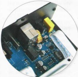
Il segnale analogico proviene direttamente dall'elettronica a supporto della meccanica tramite il circuito di conversione interno. È presente un amplificatore di uscita di separazione che impiega un doppio operazionale di buffer.
