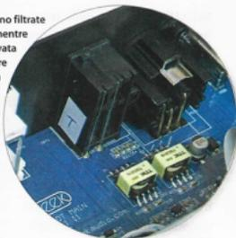
Nonostante l'alimentazione sia a 12VDC, è presente un ulteriore stadio di filtraggio e stabilizzazione che indica la propensione del costruttore a curare questa parte del circuito.
